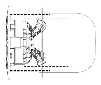
2: PUSH THE NICHE ADAPTOR INTO THE WALL SO IT SITS FLUSH AND IS FULLY INSERTED INTO THE NICHE
